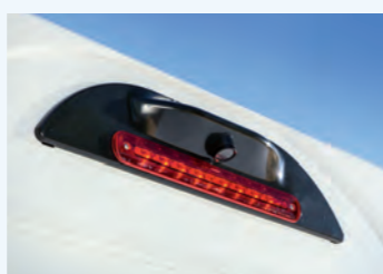
Kamera cofania wbudowana w tylny panel.
