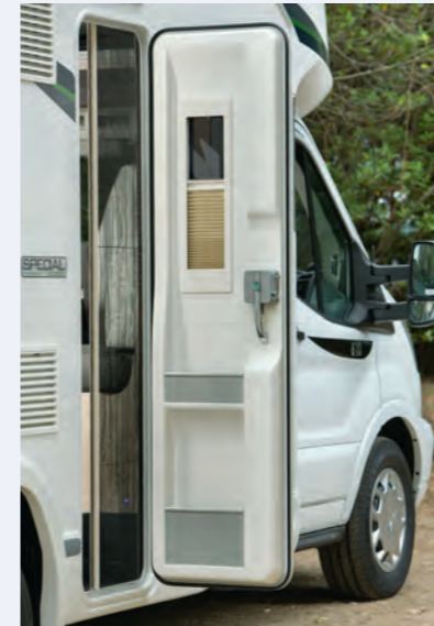
Drzwi wejściowe z oknem i żaluzją
